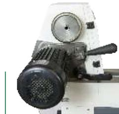
Drehbarer Drechselkopf mit Handrad
