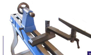
ausschwenkbare Handauflage für große Werkstücke
