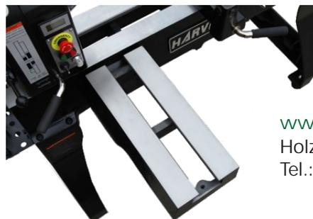
Aussendrehvorrichtung in verschiedenen Positionen verwendbar
