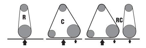
**Breitbandschleifmaschine** Typ R: Kalibrieren mit Stahlwalze oder Gummiwalze (optional) **Breitbandschleifmaschine**
